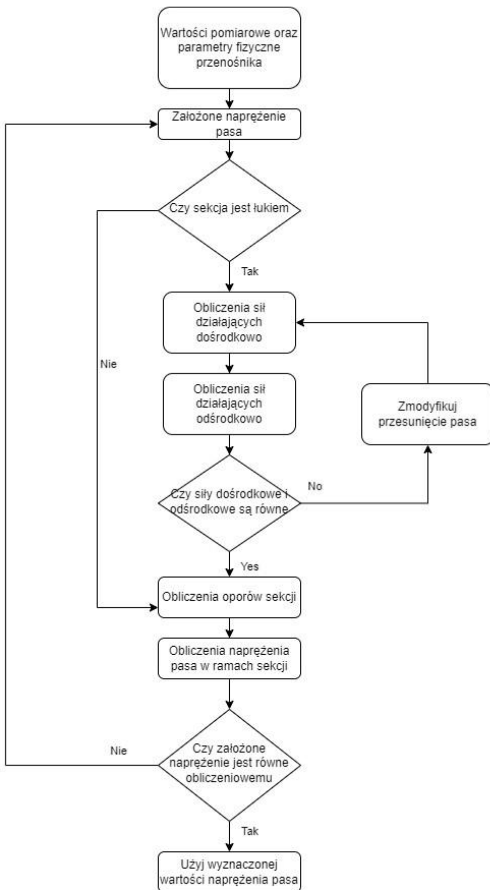
Rysunek 6.3 Procedura napięcia taśmy oraz przesunięcia taśmy na łukach.
