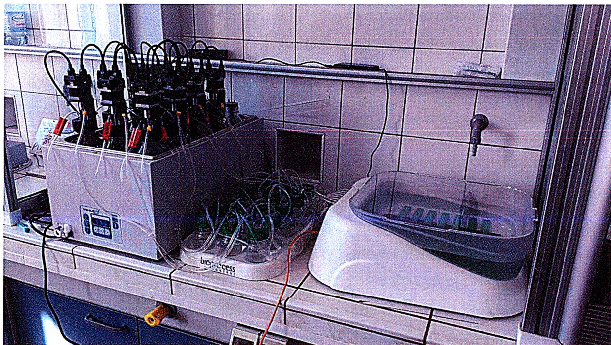
Rysunek 6. Automatyczny system pomiaru potencjału metanowego firmy Bioprocess Control.
