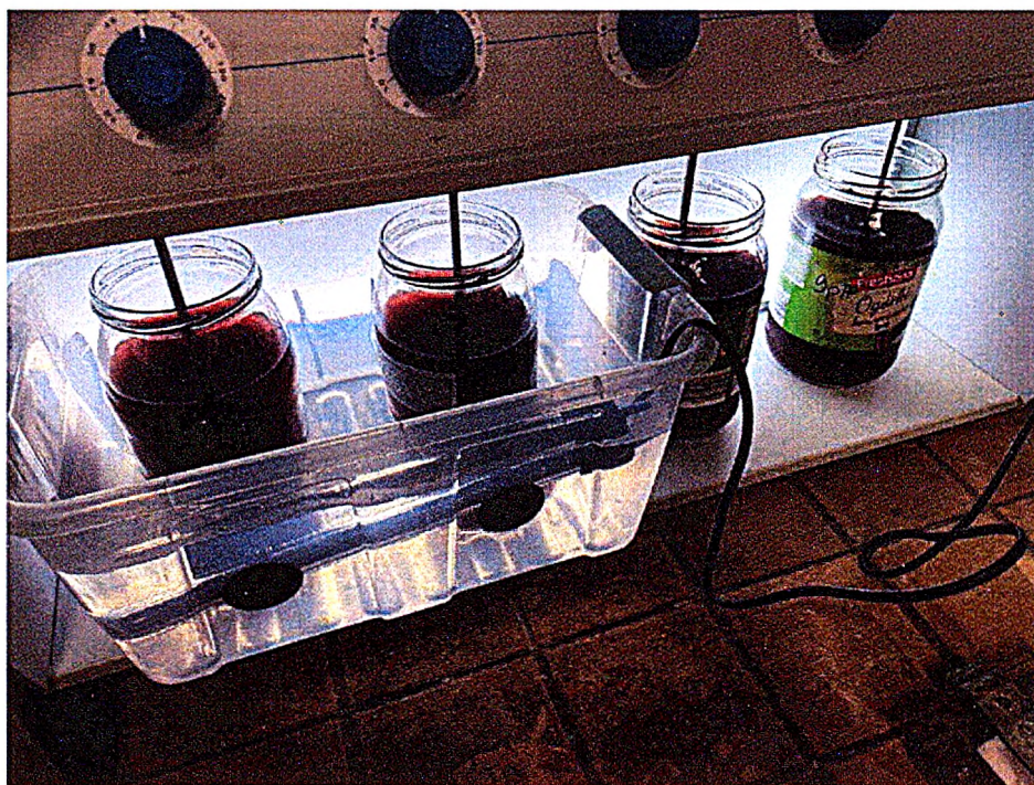
Rysunek 30. Flokulator z próbkami ścieków poddanymi hydrolizie.
