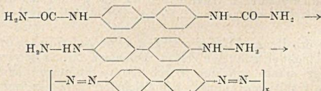
In der Tat entstehen auf diesem Wege stark braun gefärbte Verbindungen, die jedoch bromhaltig sind. Es muß also bei unseren Reaktionsbedingungen gleichzeitig eine Substitution der Benzolkerne eingetreten sein. Das Abbauprodukt des 3,3'-Dimethyl-4,4'-diphenyl-diharnstoffes ist nur in Äthylenchlorhydrin gut löslich und kann daraus mit Äther gefällt werden.
