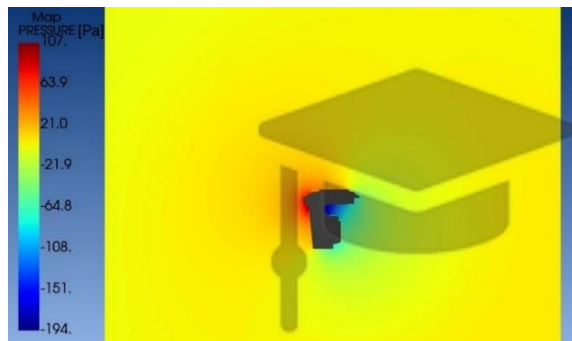
Rys. 77. Rozkład ciśnienia akustycznego [Pa] w przypadku „luźno” zamocowanej przekładni – częstotliwość 200 Hz
