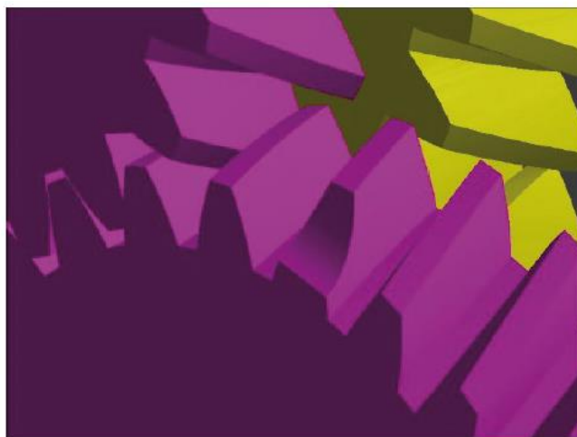
Rys. 15. Modelowanie uszkodzenia koła zębatego w modelu numerycznym – fizyczne uszkodzenie zęba (modyfikacja geometrii zęba)
