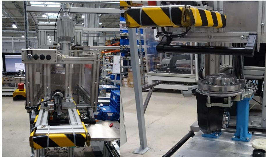
Rys. 89. Komora testowa wraz z testowanym napędem stanowiąca wyposażenie linii 18
