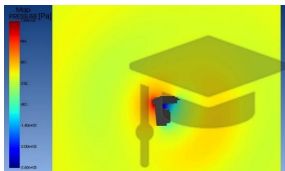
Rys. 78. Rozkład ciśnienia akustycznego w przypadku „luźno” zamocowanej przekładni – częstotliwość 377,97 Hz
