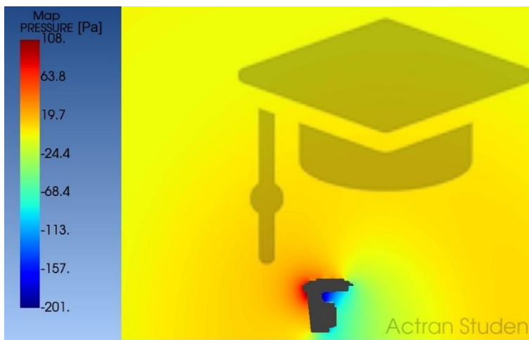
Rys. 82. Rozkład ciśnienia akustycznego w przypadku przekładni pracującej przy podłodze – częstotliwość 200 Hz
