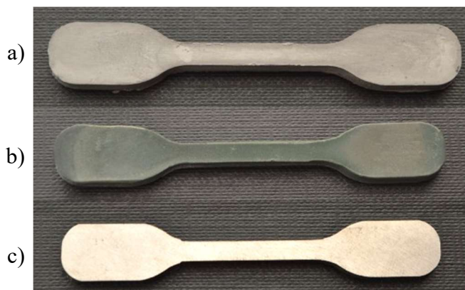
Rysunek 4.3.13. Próbkę wytwarzane w technologii MIM, a) po formowaniu, b) po spiekaniu, c) po spiekaniu i szlifowaniu.
