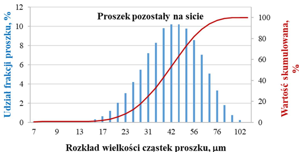
Rysunek 4.1.3. Rozkład wielkości cząstek proszku Co-Cr-Mo który pozostał na sicie
