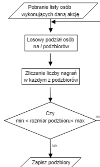
Rysunek 22: Schemat blokowy algorytmu podziału na k -podzbiorów walidacyjnych (treningowych/testowych)
