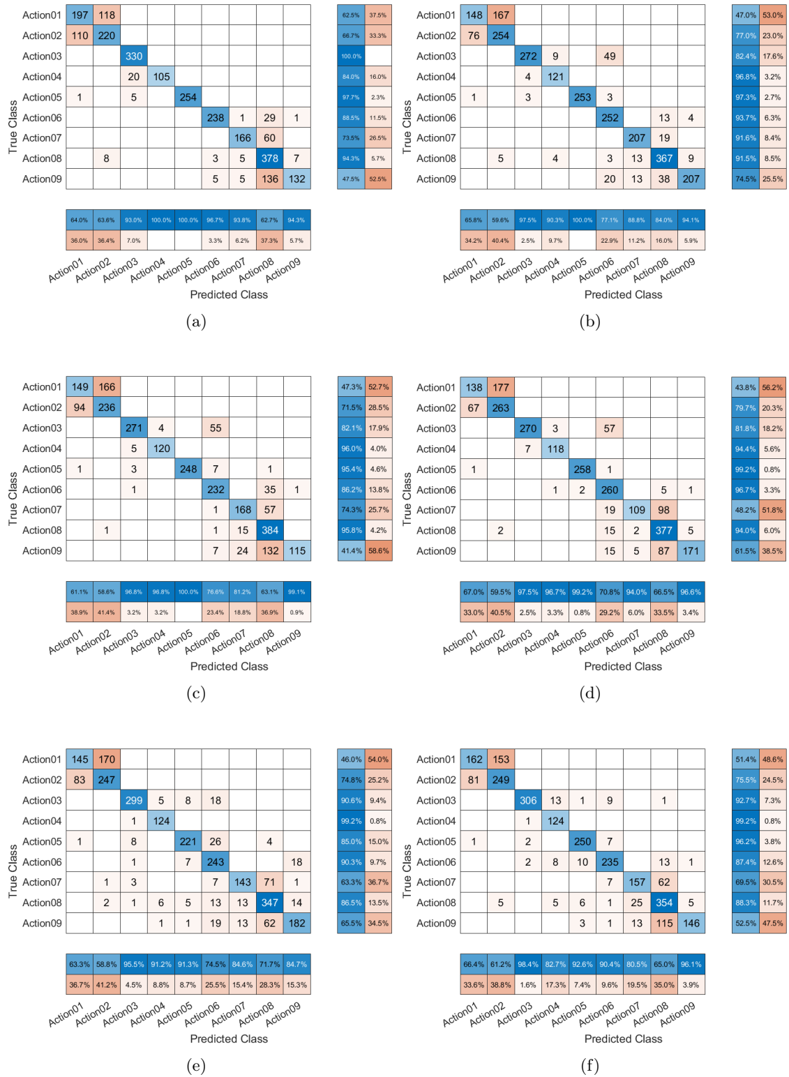
Rysunek 111: Macierze pomyłek dla sieci CNN w wybranym punkcie dla różnej liczby markerów w wektorze wejściowym: (a) 28, (b) 22, (c) 16, (d) 13, (e) 9 i (f) 6.
