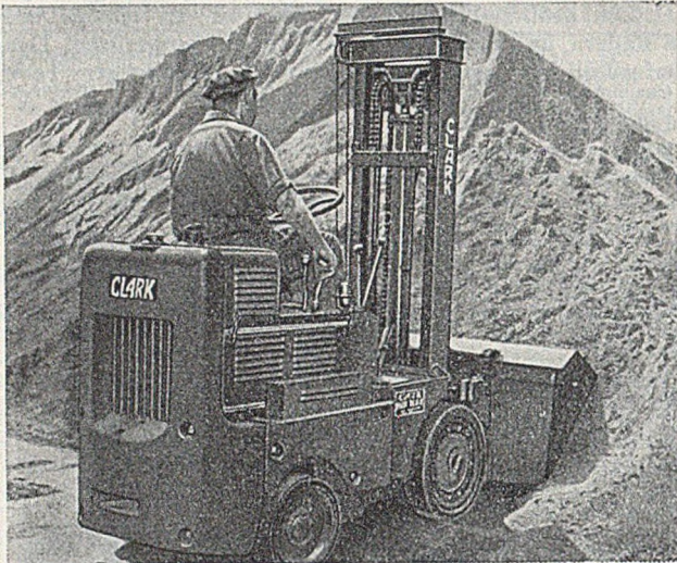
Abb. 9. Aufnahme von losem Sand durch die Schaufel des Clark-Hebetransporters zur Weiterförderung nach der Baustelle.
