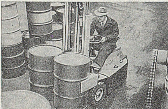
Abb. 5. Hyster-Hebetransporter mit Ladearmen ausgerüstet zum Transport und Stapeln von Ölfässern (je 55 Gallonen) in senkrechter Lage.
