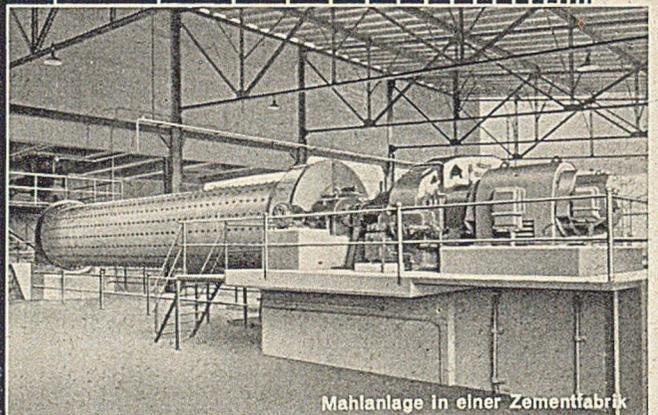
Mahlanlage in einer Zementfabrik
