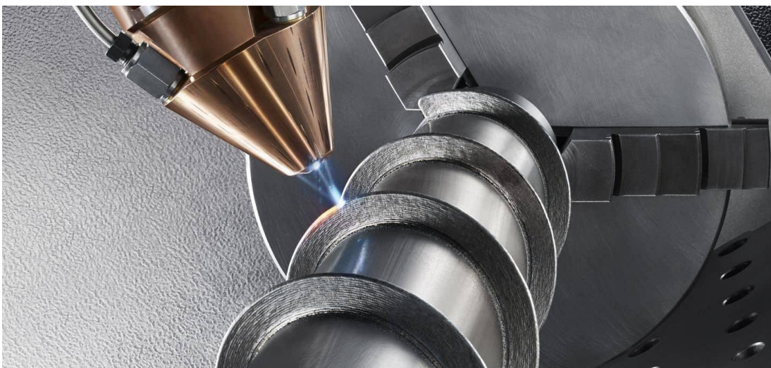
Rys. 3.9. Przykładowe zastosowanie drukowania 3D typu PA-DED
