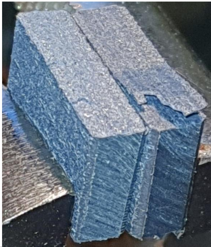
Rys. 4.43. Widok przelomu próbki PEEK_CF10_10
