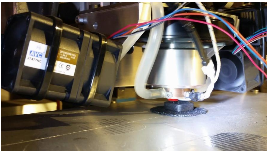
Rys. 4.12. Widok zamontowanej w drukarce 3D głowicy rotującej w trakcie pracy
