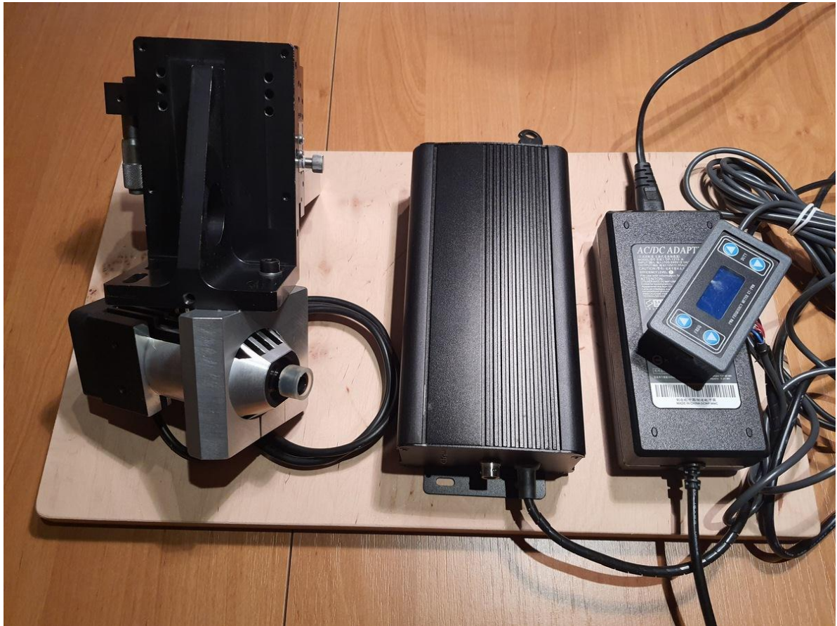
Rys. 4.20. Zestaw źródła lasera o mocy 8W i długości fali wiązki światła 808 nm
