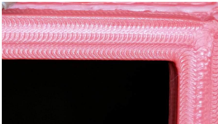
Rys. 4.5. Widok powierzchni próbki wydrukowanej na drukarce 3D z głowicą rotującą
