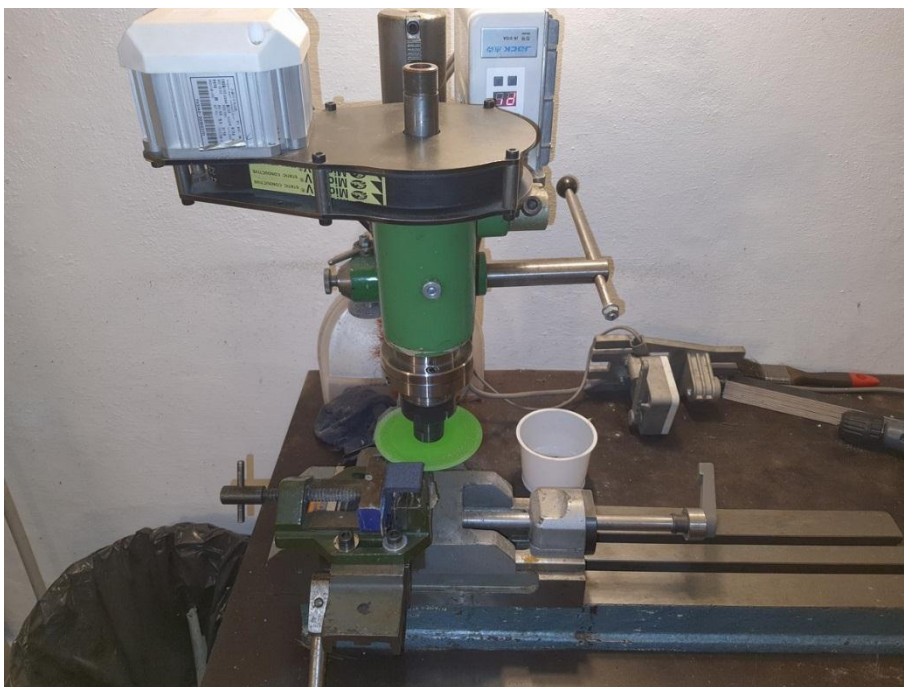
Rys. 4.18. Obrabiarka uniwersalna OUS-1 zaadaptowano do wycinania próbek
