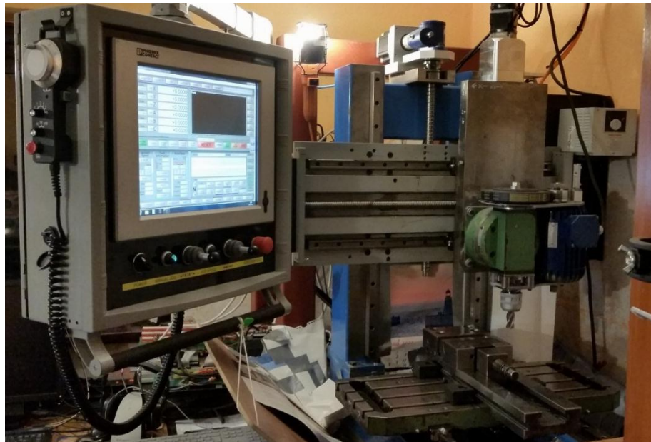
Rys. 4.6. Obrabiarka CNC zaadaptowana do zbudowania drukarki 3D FDM z głowicą rotującą
