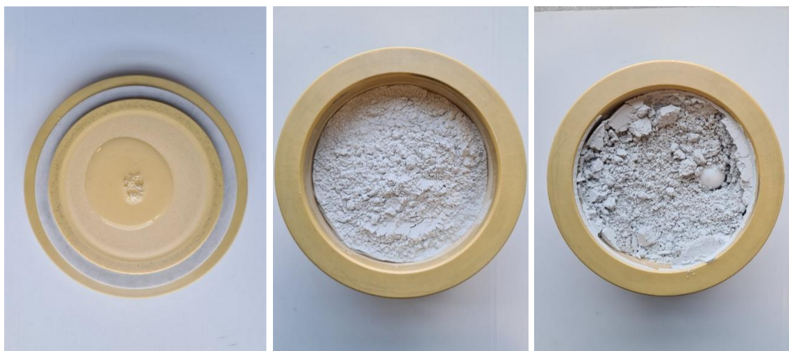
Rys. 16. Pokrywka naczynia mielącego z odmierzoną ilością gliceryny oraz naczynie mielące wypełnione szkłem, przed i po mieszaniu.
