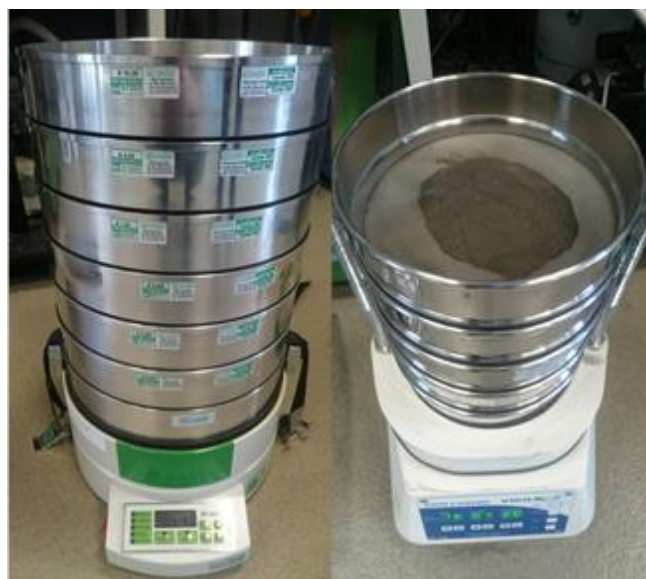
Rys. 21. Wytrząsarki laboratoryjne, odpowiednio, firmy Multiserw o średnicy sita 30 cm oraz firmy Haver&Boecker EML 200 digital plus o średnicy sita 20 cm.
