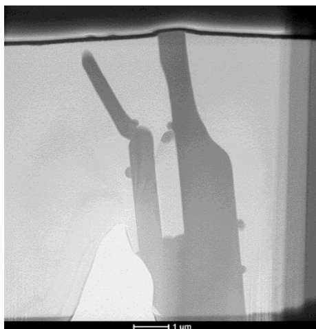
Rys. 104 Struktura próbki AZ31+Ce/700. Lamelka wycięta z drugiego obszaru. Obraz BF
