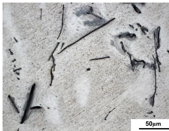
Rys. 33 Mikrostruktura stopu: a) AZ31+Ce/650, b) AZ31+Ce/700 i c) AZ31+Ce/750, LM
