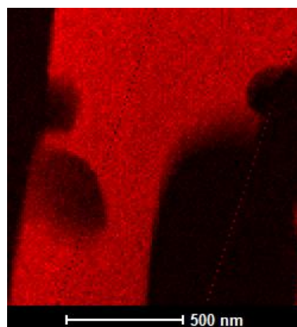
Rys. 104 Struktura próbki AZ31+Ce/700. Lamelka wycięta z drugiego obszaru. Obraz BF
