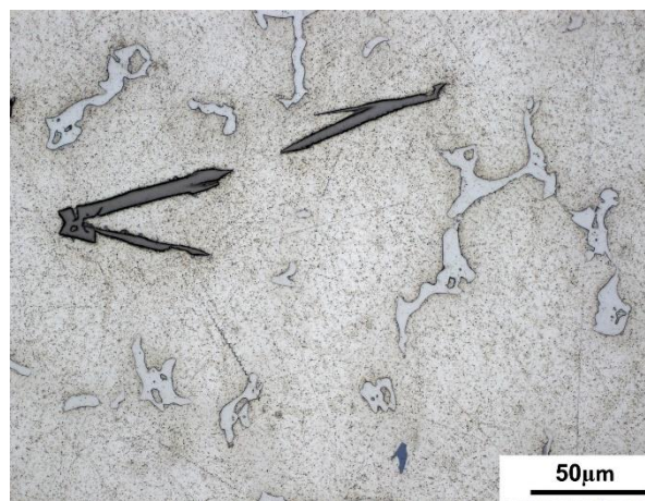
Rys. 36 Mikrostruktura stopu: a) AZ91+Ce/650, b) AZ91+Ce/700 i c) AZ91+Ce/750, LM
