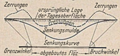
Abb. 4. Verzernte Darstellung der Bodenbewegungen — Zerrungen und Pressungen — über einer Abbaufläche.
