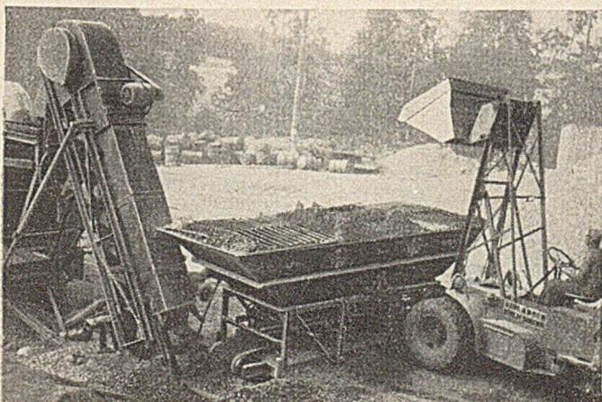
Abb. 8. Wibau-Dosierapparat für 3 Körnungen, Leistung bis 40 t/h.
