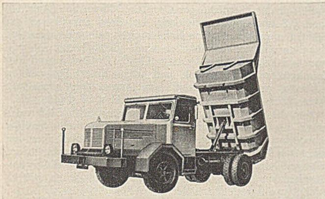
Abb. 15a. Hinterkipper, Fabrikat Südwerke, 6,2 m<sup>3</sup> Inhalt, 210 PS, Gewicht 10000 kg.
