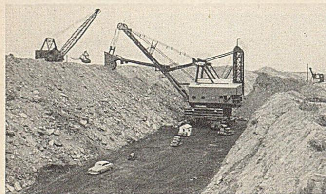
Abb. 6. Einblick in einen amerikanischen Steinkohlentagebau mit Löffelgroßbagger Bucyrus-Erie 1050 B zur Freilegung des Kohlenflözes und Schleppe-schaufelbagger (links oben) zum Einebnen der aufgeworfenen Abraumhalde.
