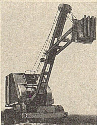
Abb. 17 c. Autobagger, Fabrikat Gottwald, 0,4 m<sup>3</sup> Inhalt, 36 PS, Gewicht 11 000 kg.
