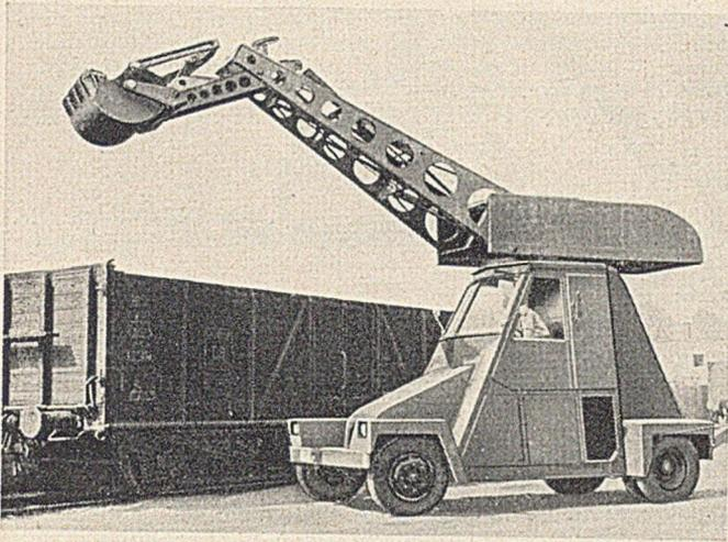
Abb. 23. Schaufellader, Fabrikat Fredenhagen, 0,4 m<sup>3</sup>, 28 PS, 5800 kg mit hydraulischem Antrieb.
