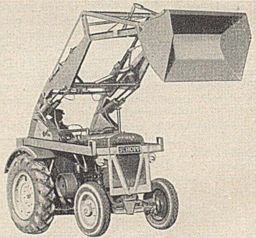
Abb. 22 b. Frontlader, Fabrikat Deutz-Schopf, 1500 kg, 50 PS, 1300+3700 kg.
