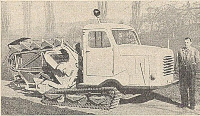
Abb. 18. Grabenbagger, Fabrikat Homburg, 20 PS, Grabenbreite 0,4 m, Tiefe 1,5 m, 4000 kg Gewicht.
