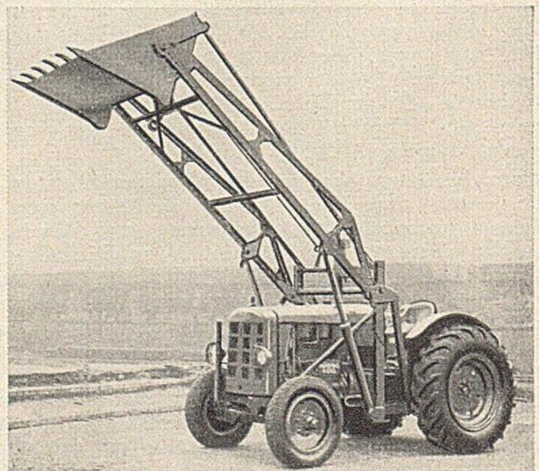
Abb. 22 c. Frontlader, Fabrikat Hanomag-Wittenburg, 1000 kg, 45 PS, 800+3200 kg.
