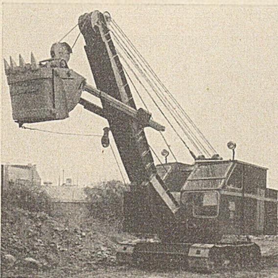
Abb. 9. 0,5-m<sup>3</sup>-Hochlöffelbagger mit selbsttätigem Löffelvorschub.
