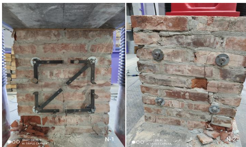
Fot. 5.1.5-2. Modele próbne N1 i N2 w chwili osiągnięcia max wytrzymałości na ściskanie Photos 5.1.5-2. Trial models N1 and N2 at the moment of reaching the maximum compressive strength
