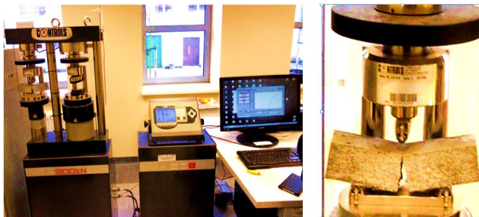
Fot. 4.5.1-2. Stanowisko wytrzymałościowe podczas badania wytrzymałości na rozciąganie przy zginaniu stwardniałych próbek zaprawy naprawczej
