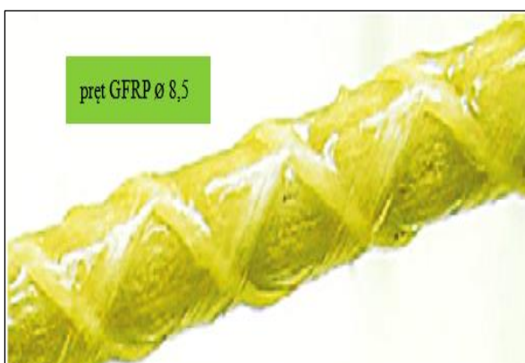
Fot. 4.7-1. Powierzchnia pręta kompozytowego GFRP z dwoma wtopionymi zwojami [W 16] Photo 4.4-1. Surface of a GFRP composite bar with two embedded coils [W 16]
