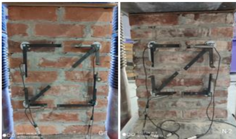
Fot. 5.1.3-1. Widok metalowej ramki z transformatorowymi czujnikami przemieszczeń liniowych PJX Photo 5.1.3-1. View of the metal frame with PJX transformer linear displacement sensors PJX
