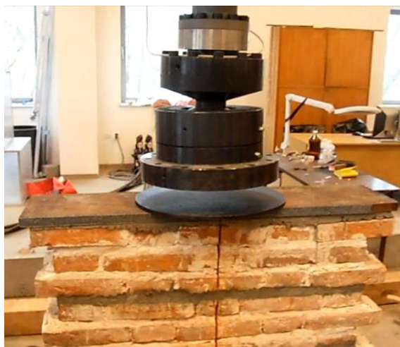
Fot. 5.2.3-2. Widok siłownika nad elementem badawczym Photo 5.2.3-2. View of the actuator above the test element
