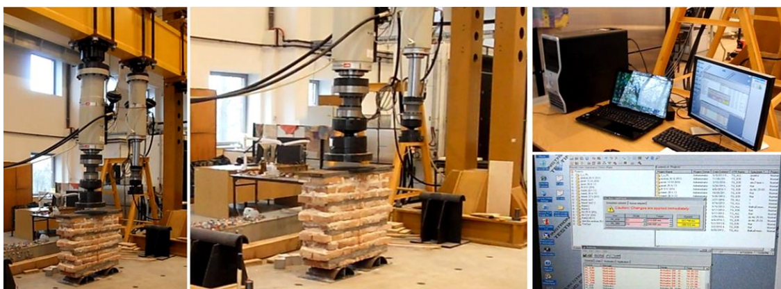
Fot. 5.2.3-3. Stanowisko badawcze zginania belek wraz ze stanowiskiem komputerowym Photos 5.2.3-3. Beam bending test station with a computer station
