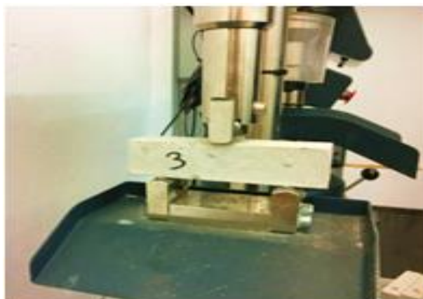
Fot. 4.4-2. Badanie wytrzymałości na zginanie próbki 3 Photo 4.4-2. Bend strenght test of the sample 3
