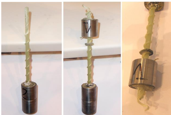
Fot. 4.7-5. Próbkę nr 1 po osiowym badaniu na rozciąganie Photos 4.7-5. Sample No. 1 after axial tensile test
