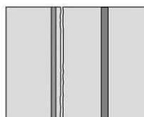
Schemat 6.3-3. Zniszczenie pod wpływem maksymalnej siły ścinającej wewnątrz elementu murowego - A.3 Scheme 6.3-3. Scheme 6.3-1. Destruction under the maximum shear force inside the masonry unit - A.3
