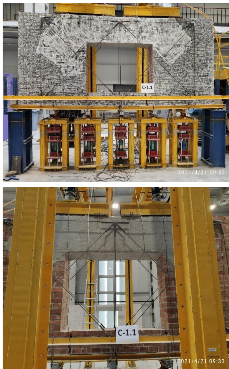
Fot. 8.4.2-1. Widok obustronnie wzmocnionego powierzchniowo elementu badawczego C.1 Photos 8.4.2-1. View of the C.1 test element, reinforced on both sides, on the test stand
