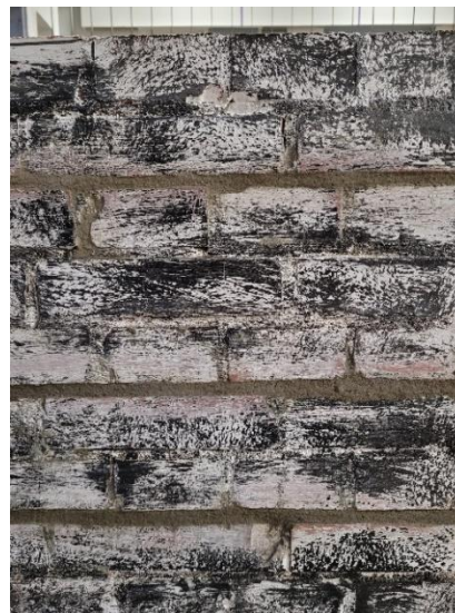
Fot. 8.4.2-4. a) Widok prętu GFRP w bruzdzie naprawczej; b) widok fragmentu elementu badawczego po uzupełnieniu spoiny zaprawą naprawczą
