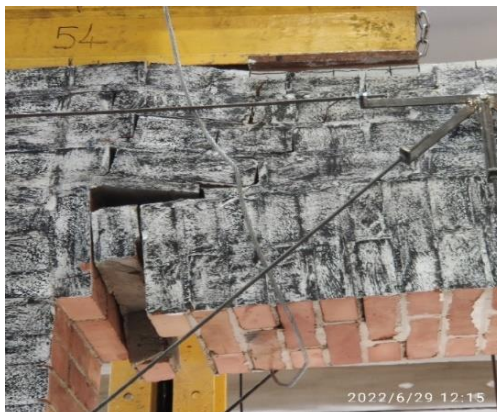
Fot. 8.4.1-5. Widok uszkodzeń z lewej strony łuku nadproża elementu badawczego C.2 Photo 8.4.1-5. View of the damage on the left side of the lintel arch of test element C.2
