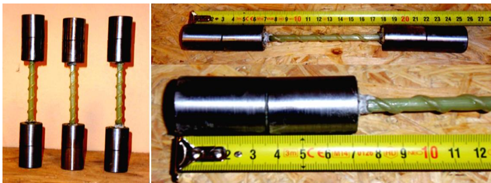
Fot. 4.7-3. Próbkę prętów kompozytowych do badania osiowego rozciągania w maszynie wytrzymałościowej Photos 4.7-3. Composite bar specimens for axial tensile testing in the testing machine
