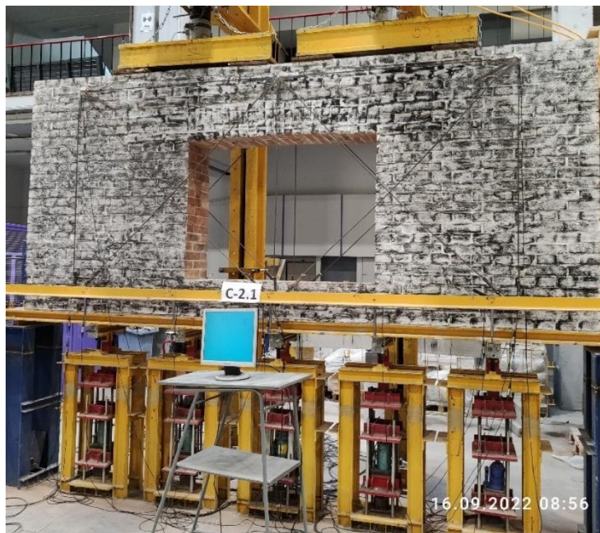
Rys. 8.3-4. Widok elementu badawczego C.2-1 na stanowisku badawczym Fig. 8.3-4. View of test element C.2-1 on the test stand
