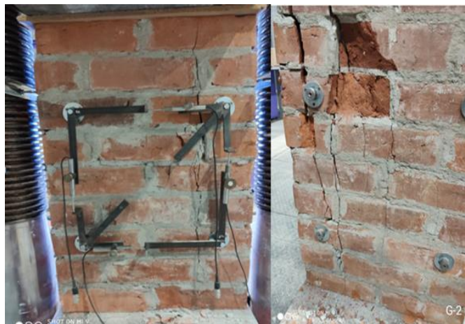
Fot. 5.1.5-1. Modele próbne G1 i G2 w chwili zniszczenia Photos 5.1.5-1 Test models G1 and G2 at the time of destruction
