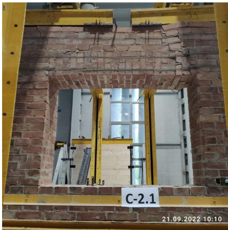
Fot. 8.4.3-4. Widok elementu badawczego C.2-1 w trakcie obciążania Photo. 8.4.3-4. View of test element C.2-1 during loading
