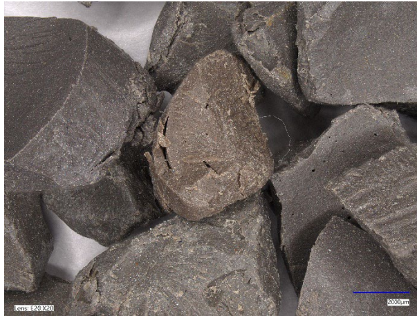
Rys. 7. Kruszywo uzyskane z odpadów tworzyw sztucznych – skala 2000 \mu\text{m} Fig. 7. Crushed plastic waste – 2000 \mu\text{m} scale
