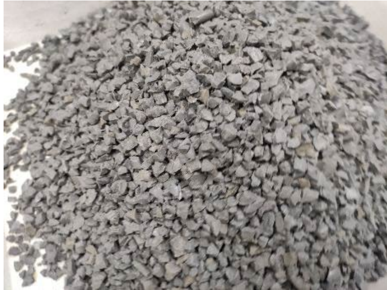
Rys. 2. Kruszywo lekkie z tworzyw sztucznych PET/PVC/OPS Fig. 2. PET/PVC/OPS lightweight plastic aggregate
