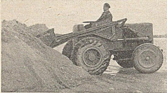
Zettelmeyer-Schaufellader HK I, 30 PS-Dieselmotor, Gewicht 3350 kg.
