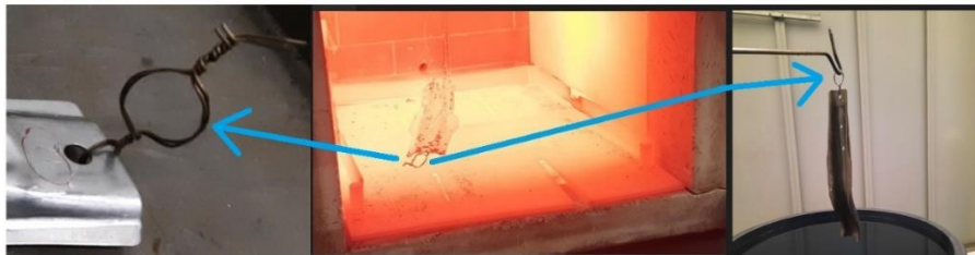
Rys. 56. Sposób mocowania i transportu części z pieca do wanny hartowniczej
