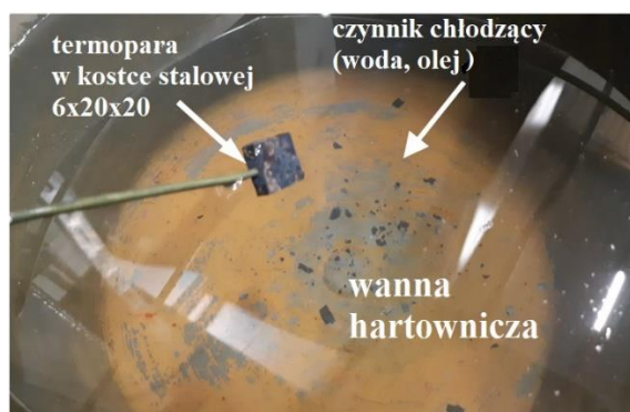
Rys. 53. Sposób umieszczenia termopary w płytce stalowej
