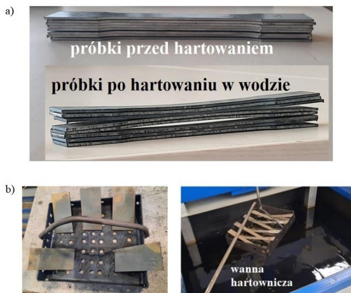
Rys. 96. Zmiany kształtu próbki po hartowaniu w wodzie: a) porównanie próbek przed i po hartowaniu, b) sposób ułożenia próbek podczas obróbki cieplnej
