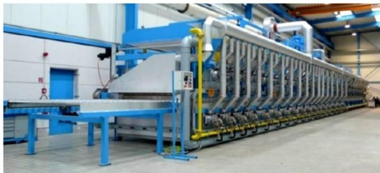
Rys. 29. Piec gazowy z rolkowym systemem transportu [115]
