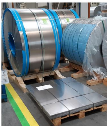
Rys. 47. Blacha w kręgu oraz wycięte płaskie arkusze do badań
