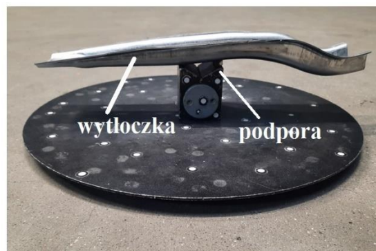
Rys. 74. Sposób podparcia wytłoczki podczas skanowania
