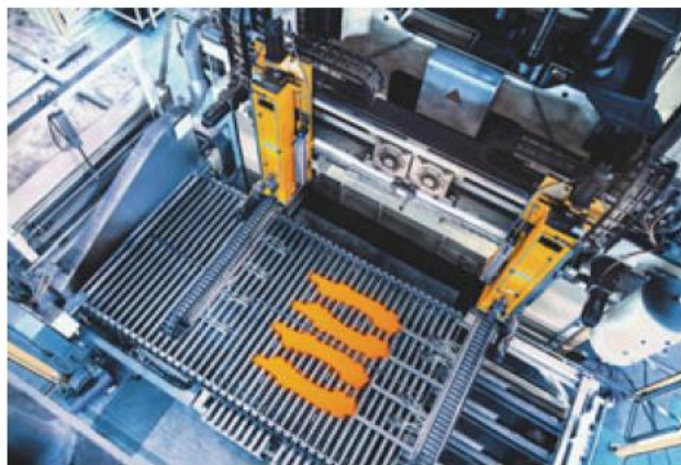
Rys. 25. System transportu półfabrykatów umożliwiający produkcję 4 części na uderzenie prasy [99]
