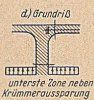
Abb. 16 d) (zu B). Untersuchung der O. W. Krafthauswand als seitlich auskragende Platte aus den Turbinenkammerwänden (Horizontalbewehrung). Ermittlung der Momente und Schubkräfte.
