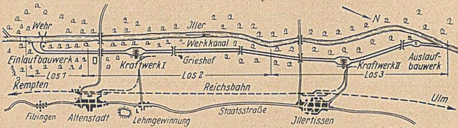
Abb. 1. Lageplan einer Wasserkraftanlage a. d. Iller mit 2 Staufufen mit je 14,5 m Nutzgefälle und 15 000 PS Leistung.
