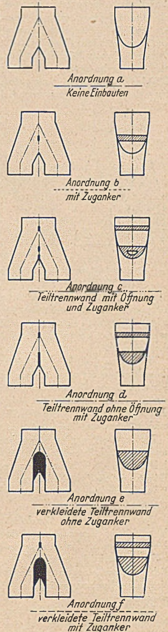
Bild 5. Einbauten im Hosenrohr.
