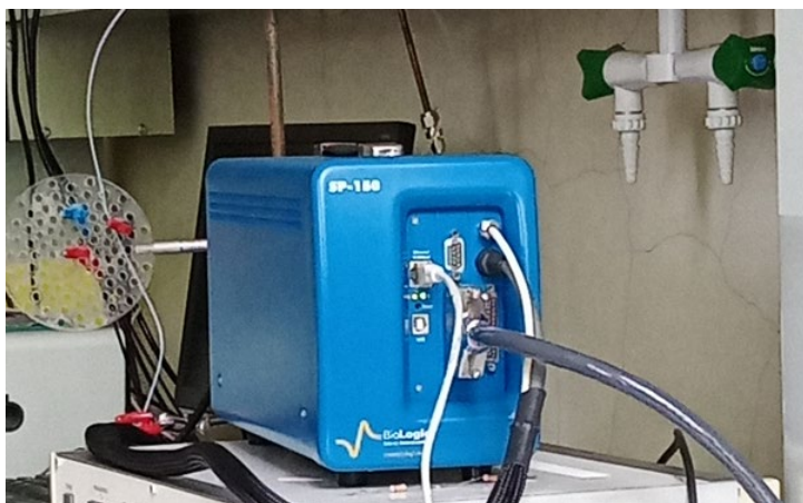
Rys. 3.1. Potencjostat Bio-Logic SP-150 [15]
