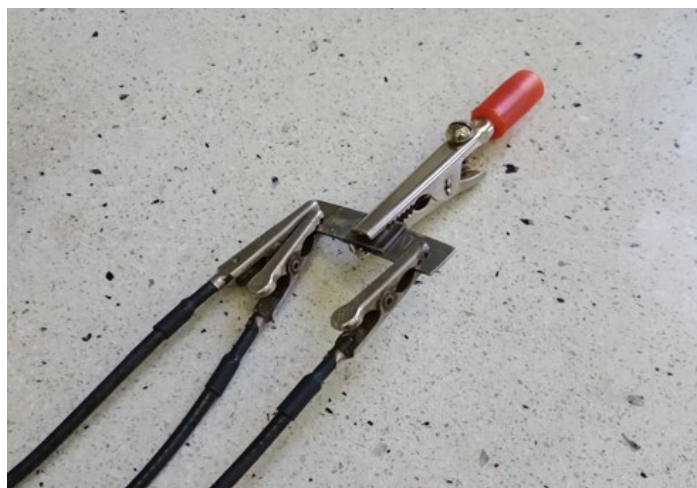
Rys. 3.6. Zdjęcie superkondensatora podczas pomiarów EIS [15]
