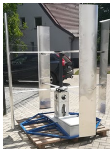
Rys. 4.3. Turbina H-rotor – zbudowany prototyp Fig. 4.3. H-rotor turbine – built prototype
