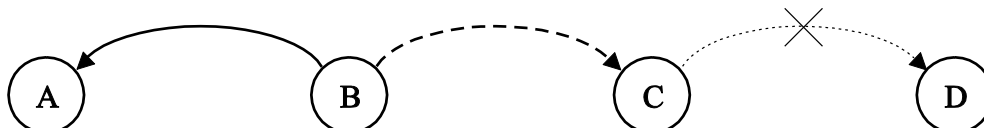
Rys. 1.4. Ilustracja zjawiska stacji odkrytej Fig. 1.4. An illustration of exposed station phenomenon
