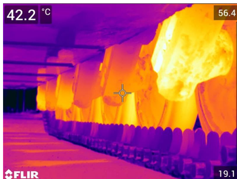
Rys. 4. Przykładowy rozkład temperatury wahaczy po jeździe w terenie nieutwardzonym (droga gruntowa) Fig. 4. Example temperature distribution of the rockers after driving on unpaved terrain (off road)
