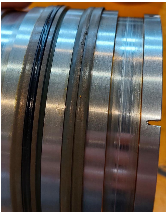
Rys. 6. Uszkodzone uszczelnienie typu Stepseal 2k
