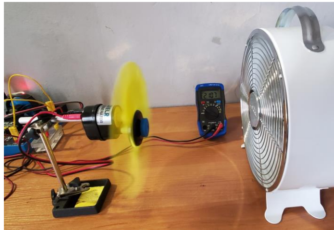
Fig. 7. Investigation of potential position for Wind turbine Rys. 7. Badanie potencjalnego położenia turbiny wiatrowej
