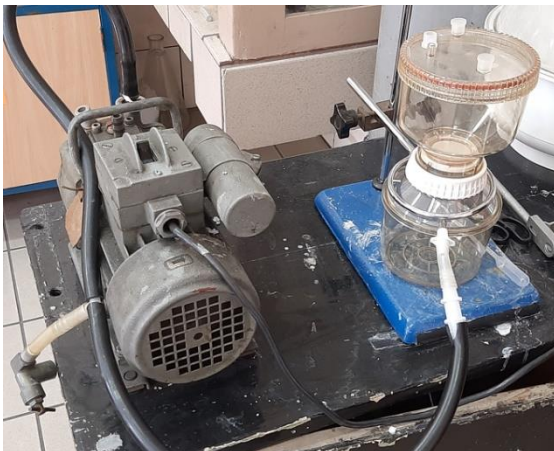
Fig. 9. Actual vacuum filtration setup (own study)
