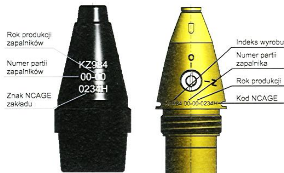
Rys. 6. Oznakowanie identyfikacyjne indywidualnego opakowania zapalnika oraz cechowanie zapalnika KZ-984
