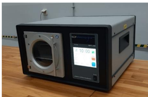
Rys. 4. Urządzenie do obróbki plazmą niskociśnieniową, HPT – 200f, firmy EDFelectronics
