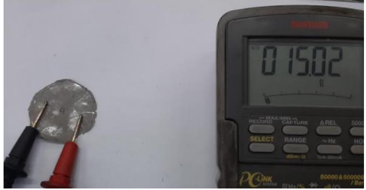
Fig. 12. Conductivity measurement of AgNWs-cellulose based sensor (own study) Rys. 12. Pomiar przewodnictwa elektrycznego czujnika AgNW-celuloza (opracowanie własne)
