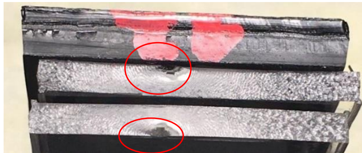
Fig. 11. Matte breakthrough with a visible area with a smooth surface Rys. 11. Przełom matowy z widocznym miejscem o gładkiej powierzchni Source: own elaboration.
