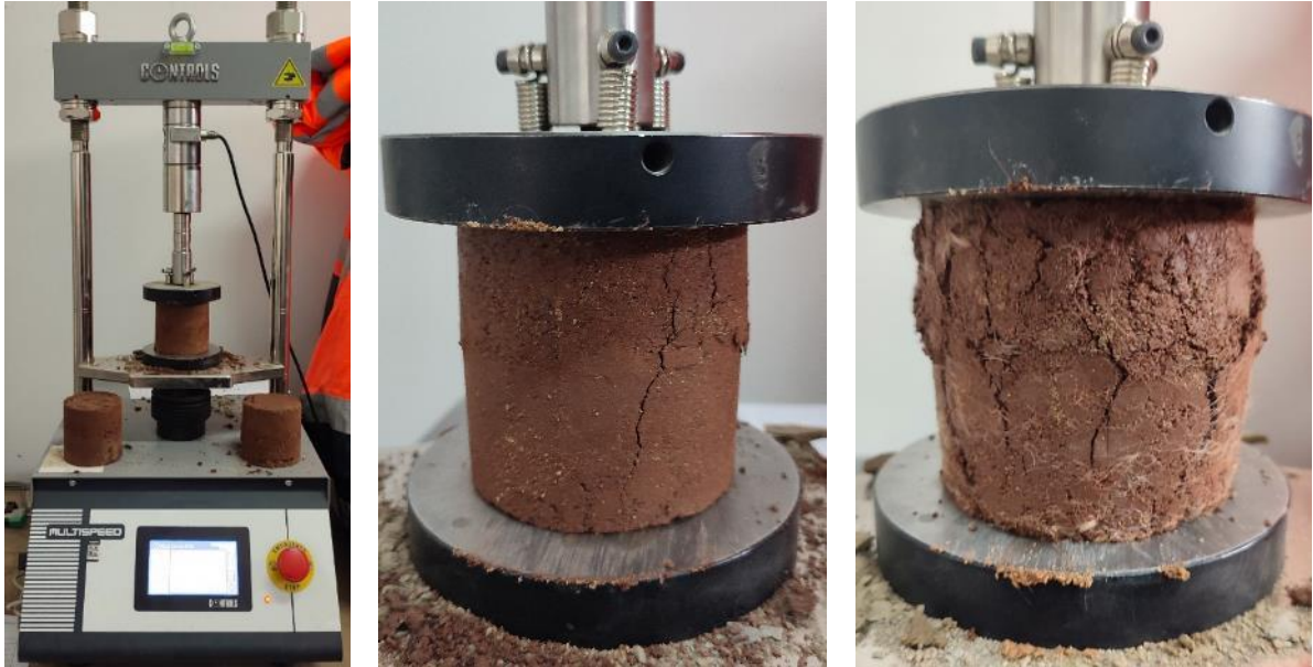
Rys. 3.1. Laboratoryjne badania jednoosiowego ściskania: (a) maszyna wytrzymałościowa, (b) próbka cementogruntu po zniszczeniu z pionowymi pęknięciami, (c) próbka cementogruntu z dodatkiem włókien po zniszczeniu z wyraźnymi pionowymi pęknięciami
