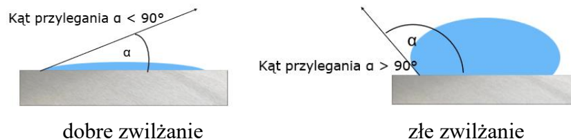
Rys. 1. Pomiar kąta zwilżania [8]
