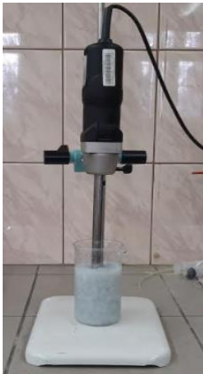
Fig. 4. Formation of cellulose suspension (own study) Rys. 4. Tworzenie zawiesiny celulozy (opracowanie własne)
