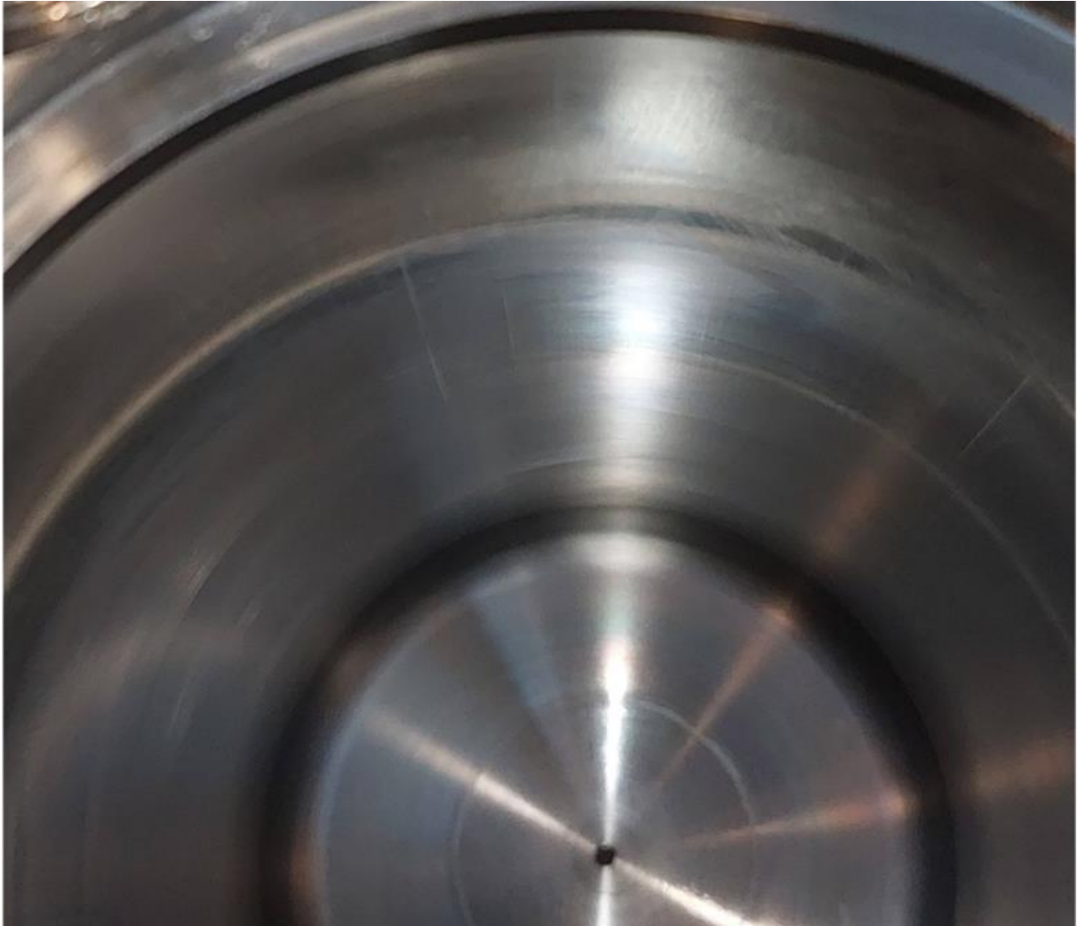
Rys. 8. Powierzchnia z widocznymi rysami wzdłużnymi
