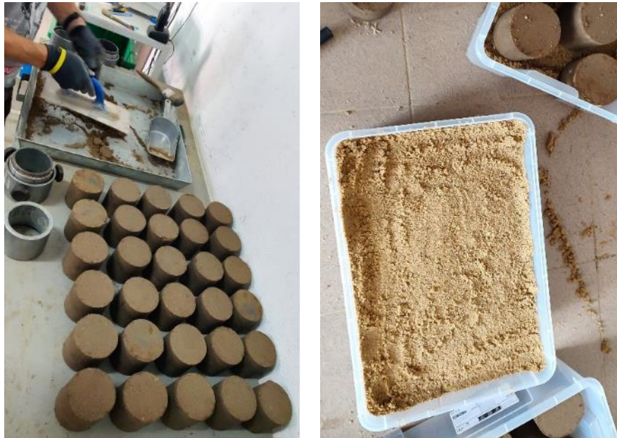
Rys. 2.6. a) Proces przygotowania próbek, mieszanie składników, zagęszczania w formach i dojrzewania próbek, b) próbki w hermetycznych pojemnikach zasypanych piaskiem
