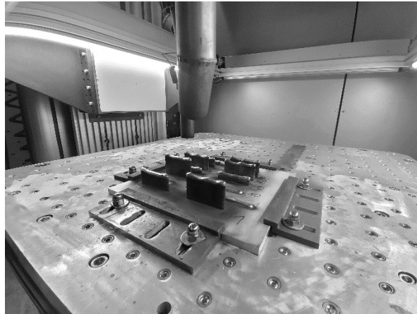
Rys. 3. Próby drukowania na blasze nierdzewnej X12Cr13
