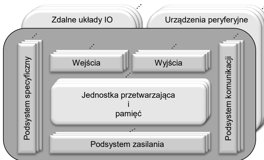
Rys. 79. Ogólny model sprzętu dla urządzeń klasy PLC Fig. 79. General hardware model for devices of PLC type
