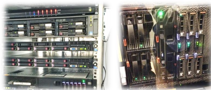
Rys. 105. Przykłady komputerów serwerowych do montażu w szafach Fig. 105. Examples of servers mounted in cabinets
