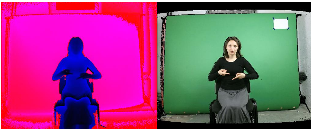
Fig. 3. Depth image and color mapped to depth projection captured by the Kinect sensor Rys. 3. Obraz głębi i koloru zmapowany na projekcję głębi, zarejestrowany przez Kinect
