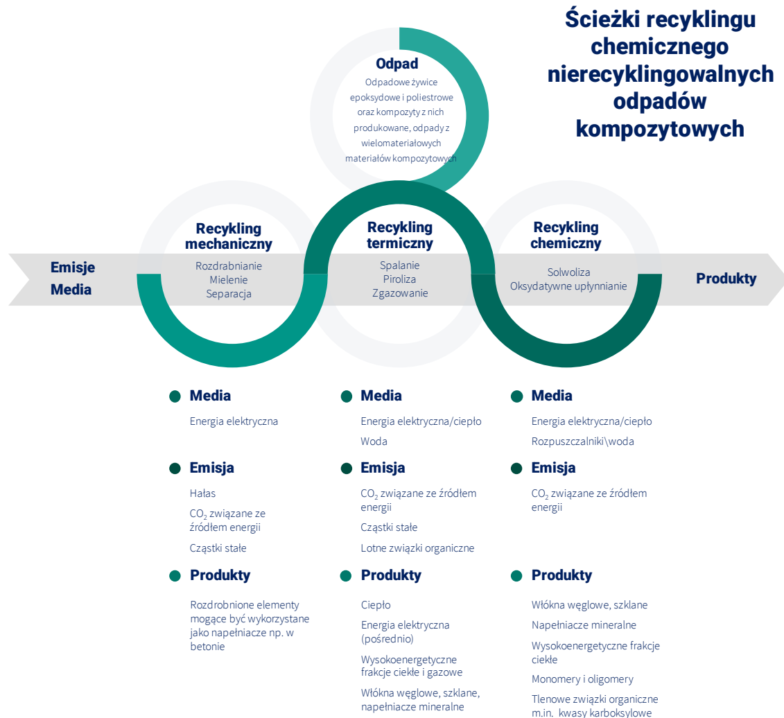
Rys. 3.33. Ścieżki recyklingu chemicznego nierecyklingowalnych odpadów kompozytowych (opracowanie własne)
