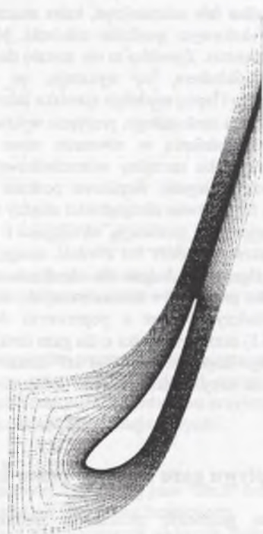
Rys. 5.20. Siatka numeryczna typu "C" (401x33) Fig. 5.20. "C"-type numerical grid (401x33)
