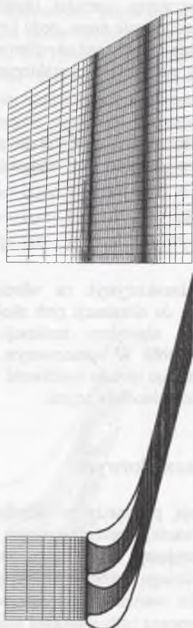
Rys.4.38. Siatka numeryczna dla kierownicy stopnia NP turbiny parowej Fig.4.38. Numerical grid for the stator of the LP part of steam turbine
