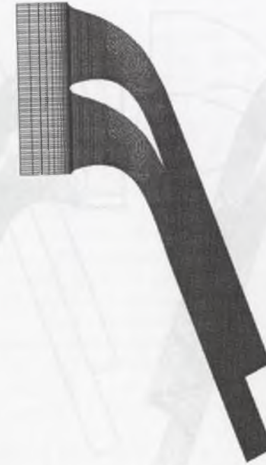
Rys.6.4. Siatka numeryczna typu "L" dla kierownicy turbiny parowej Fig.6.4. "L"-type numerical grid for stator of the steam turbine
