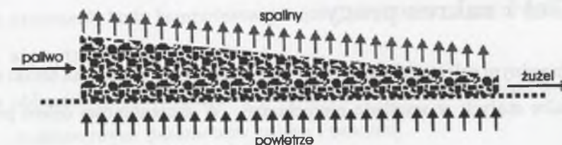
Rys.4.4. Organizacja spalania na ruszcie przesuwnym
