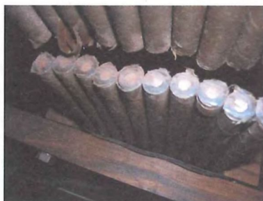
Rys. 7.16. Kontrolowane przerwanie fragmentu uzwojenia i zmiany w jego odpowiedzi częstotliwościowej FRA
