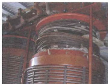
Rys. 7.14. Kontrolowane deformacje poosiowe uzwojenia i zmiany w jego odpowiedzi częstotliwościowej FRA
