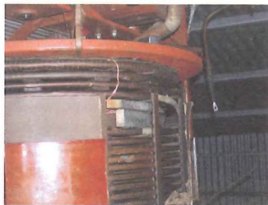
Rys. 7.14. Kontrolowane deformacje poosiowe uzwojenia i zmiany w jego odpowiedzi częstotliwościowej FRA
