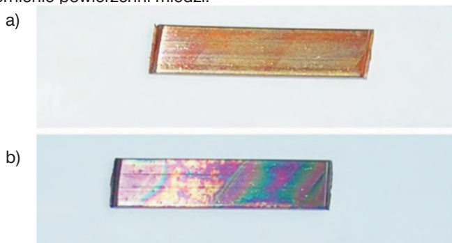
Rys. 5.5. Powierzchnie miedzi po starzeniu w oleju niekorozyjnym (a) oraz korozyjnym (b)
