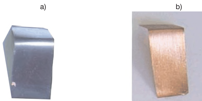
Rys. 5.18. Wpływ pasywatorów metali na pasek miedzi w badaniu wg ASTM D1275B [8,12]. Olej bez pasywatora (a), olej z dodatkiem pasywatora (b)
