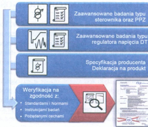
Rys.5. Schemat certyfikacji VRDT wg opracowanych przez FGH wytycznych Z 417
