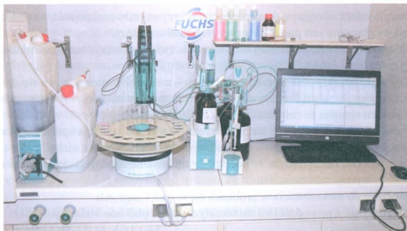
Rys.2. System analityczny przeznaczony do oznaczeń TAN/TBN w olejach smarnych. System składa się z aparatu do automatycznego miareczkowania 905 Titrandu współpracującego z autosamplerem 814 USB Sample Processor.
