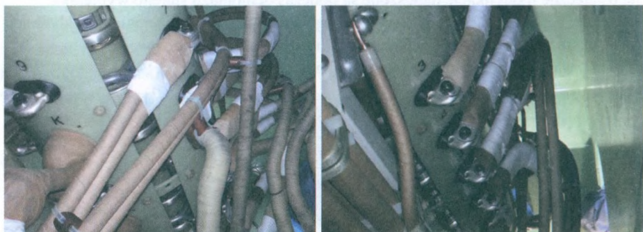
Rys. 11. Połączenia wybieraka z systemem dystansowym i mocowaniem
