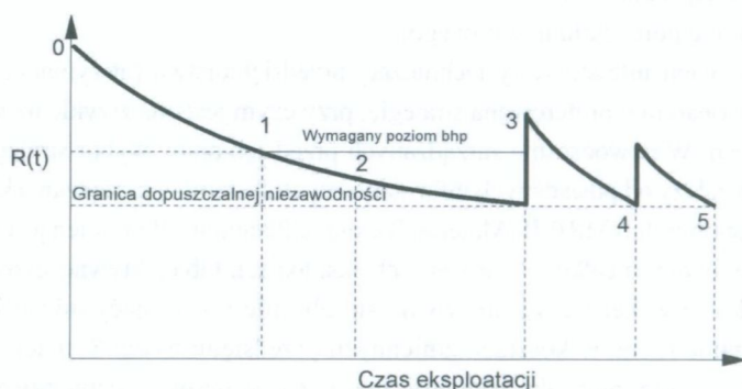
Rys. 2.1. Przebieg funkcji niezawodności w aspekcie wycofania urządzenia z eksploatacji [5]:
