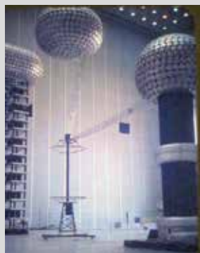
Magneto-optyczny przekładnik prądowy. Prototyp podczas próby w Laboratorium Wysokich Napięć.
