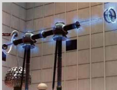
Ulot na wyłączniku podczas próby napięciowej. Laboratorium Wysokich Napięć IREQ.
