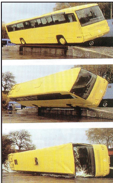
Rys. 3. Próba wytrzymałości konstrukcji nośnej autobusu przeprowadzona zgodnie z dyrektywą ECE R 66 [17]
