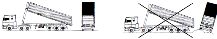
Rys. 16. Zalecenia producenta naczep samochodowych odnośnie ich rozładunku [126]
