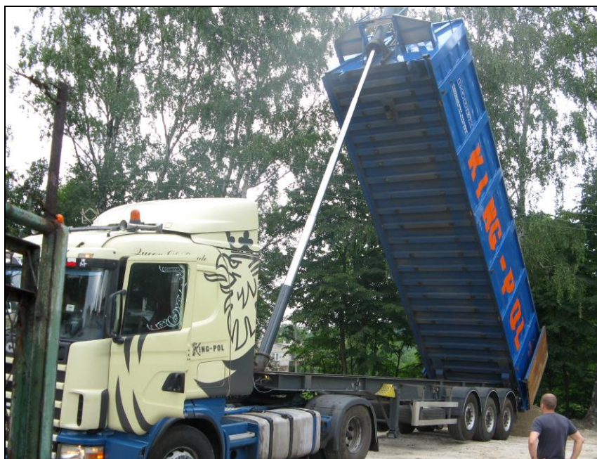
Rys. 86. Skrajne położenie skrzyni ładunkowej w czasie pomiaru naprężeń
