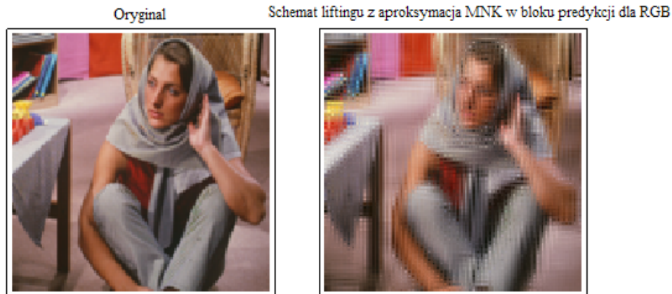
Rysunek 17.27: Badanie wrażliwości schematu liftingu na zerowanie współczynników transformaty w modelu RGB z wykorzystaniem bazy trygonometrycznej
