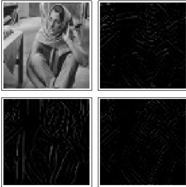
Rysunek 17.39: Analiza składowej Y obrazu za pomocą schematu liftingu w wykorzystaniem aproksymacji MNK (składowa nie podlega aproksymacji podczas transformacji w modelu YCbCr)
