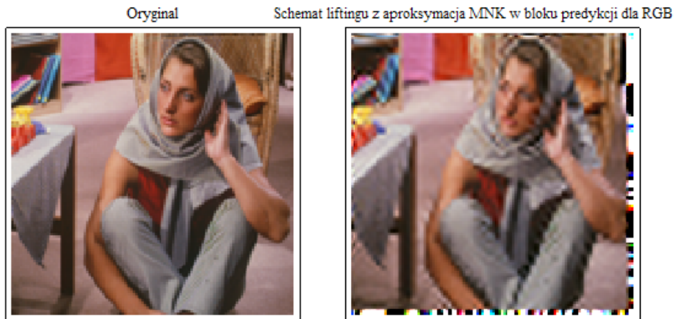
Rysunek 17.29: Badanie wrażliwości schematu liftingu na zerowanie współczynników transformaty w modelu RGB z wykorzystaniem bazy interpolacyjnej
