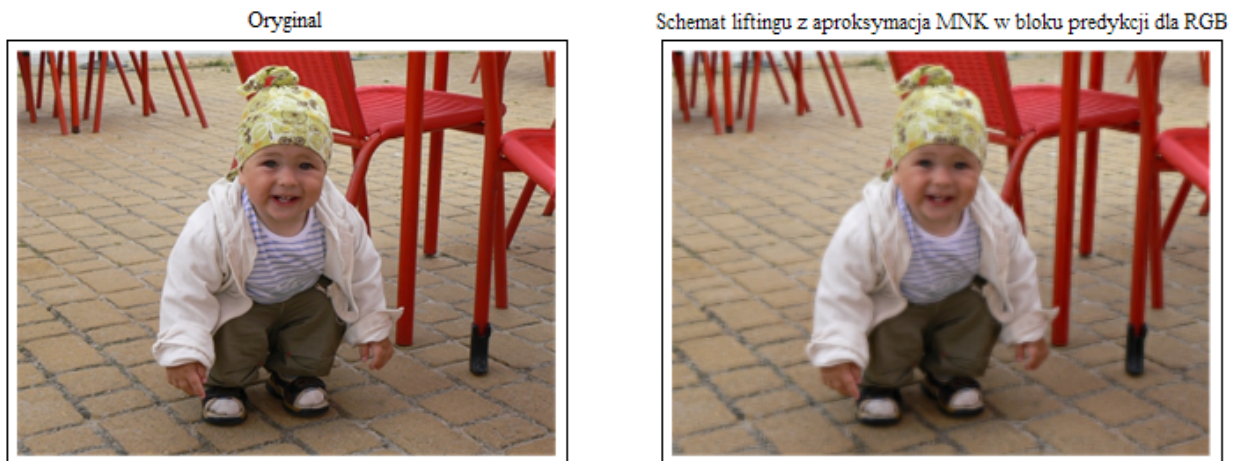
Rysunek 17.30: Zerowanie współczynników reprezentacji szczegółowej modelu RGB
