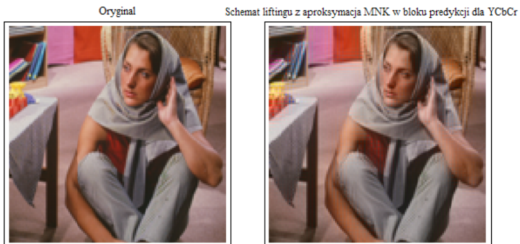
Rysunek 17.43: Badanie wrażliwości schematu liftingu na zerowanie współczynników transformaty w modelu YCbCr dla składowych Cb i Cr z wykorzystaniem bazy liniowej
