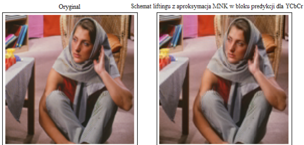
Rysunek 17.42: Badanie wrażliwości schematu liftingu na zerowanie współczynników transformaty w modelu YCbCr dla składowych Cb i Cr z wykorzystaniem bazy trygonometrycznej
