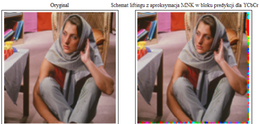
Rysunek 17.44: Badanie wrażliwości schematu liftingu na zerowanie współczynników transformaty w modelu YCbCr dla składowych Cb i Cr z wykorzystaniem bazy interpolacyjnej
