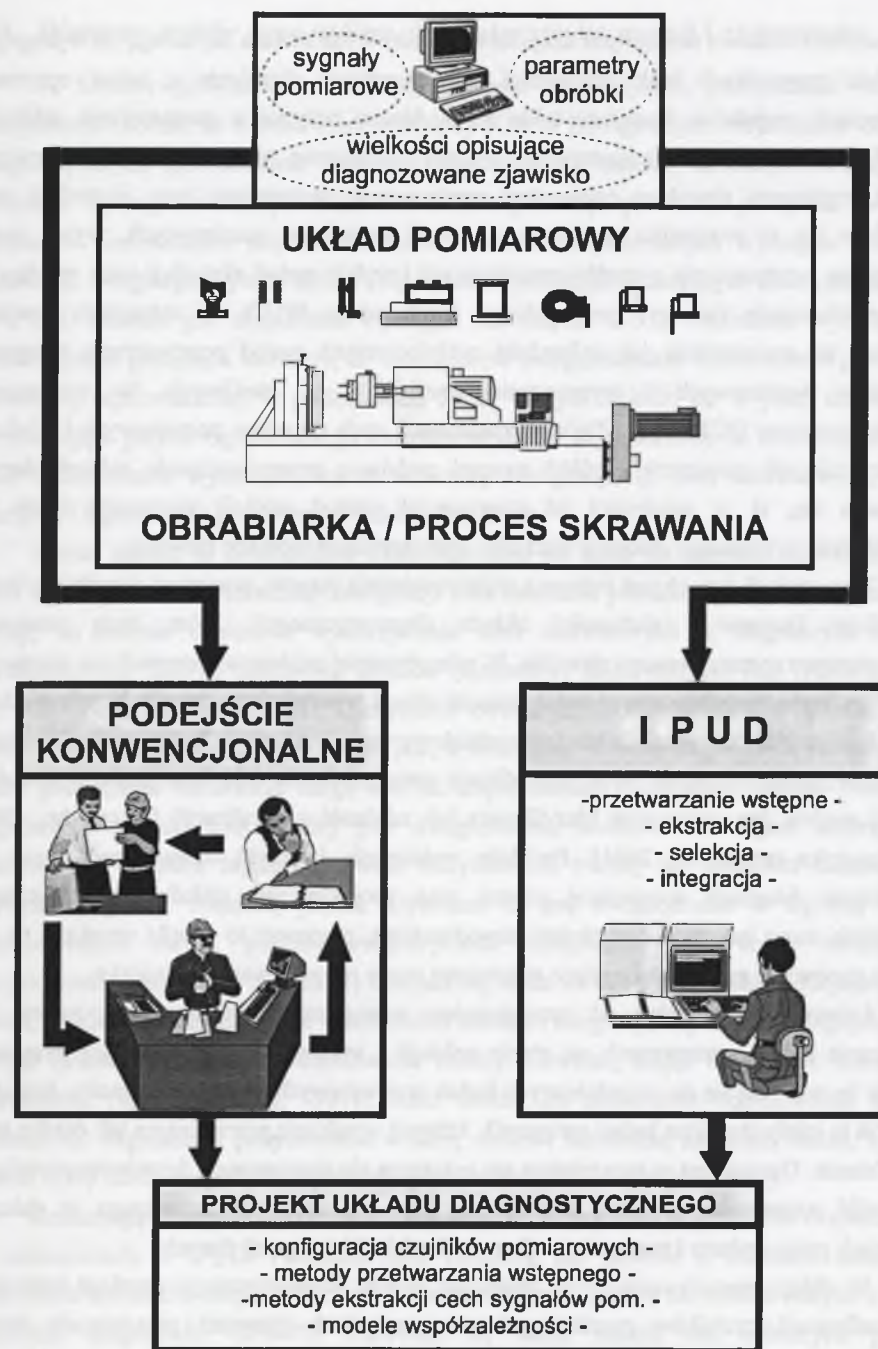
Rys. 2.2. Dwa podejścia do projektowania układów diagnostycznych OPN-PS
