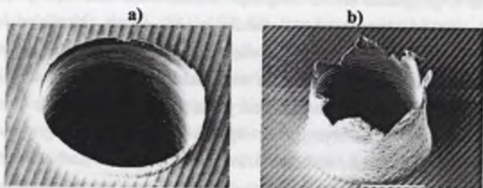
Rys. 7.1. Przykładowe postaci zadziorów tworzących się w procesie wiercenia; zadziór równomierny (a) i koronowy (b) [Min et al., 2001]
