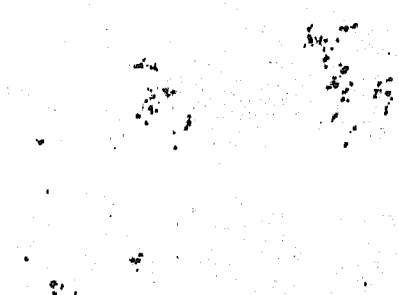
Rys. 6. Skupiska wtrąceń tlenkowych w odkuwce stali kotłowej, odlanej przy obniżonym ciśnieniu. Zgląd nietrawiony, przekrój poprzeczny. Powiększenie 100 x [58]
