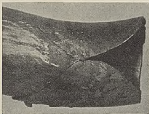
FIG. 3.—Fractured Axle-Tube B. Actual Size.
