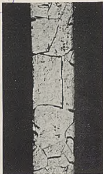
FIG. 9.—Nickel + 0.07 per cent. Magnesium.
