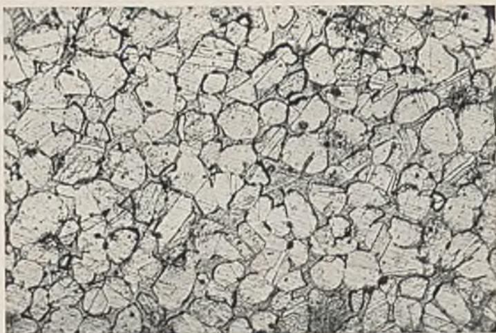
FIG. 8.—Fine Muntz Metal, MM1. \times 200 .
