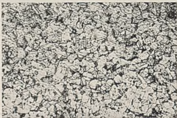
FIG. 8.—Fine Muntz Metal, MM1. \times 200 .
