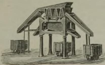
Grösste Leistungsfähigkeit von allen bis jetzt bestehenden Klassirapparaten; absolut ruhiger Gang selbst in grössten Höhen und in Verbindung mit Gebäuden; Erschütterungen der Gebäude sind ausgeschlossen; f. grosse Höhen (bei Wäschen) den Trommeln vorzuziehen; leichte u. bill. Fundamentirung;
