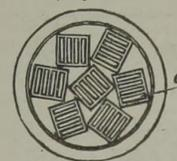
**Fernsprechkabel mit bandförmigen Leitern** von Felten & Guilleaume in Mülheim a. Rhein. Kl. 21. Elektrische Apparate. Nr. 65 930, vom 7. November 1891.
