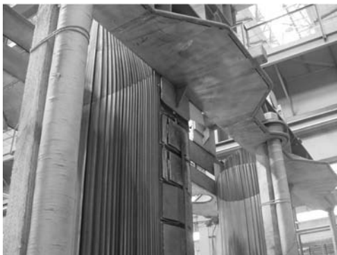
Rys. 4. Pionowe, niemagnetyczne śruby prasujące, łączące belki dolne z górnymi rdzenia dwuramowego autotransformatora RTdxP125000/200
