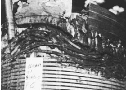
Rys. 2. (Wg. [5]). Przykład po-osiowego i promieniowego odkształcenia cewek na skutek sił dynamicznych od prądu zwarcia.
