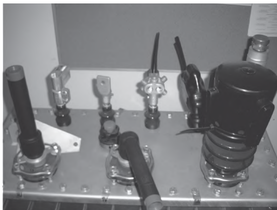
Rys. 3.26. Nowe typy przepustów stosowane w transformatorach rozdzielczych fabryki w Żychlinie oraz ich dodatkowe wyposażenie.
