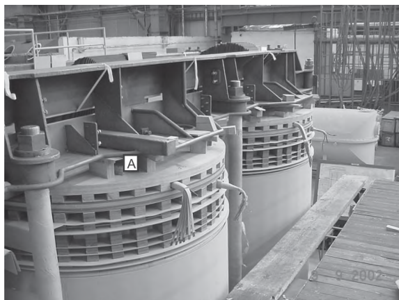
Rys. 3.9. Część wymiawalna autotransformatora RTdxP125000/200. Na górnej belce widoczny odbój A, centrujący dodatkowo położenie rdzenia względem kadzi.
