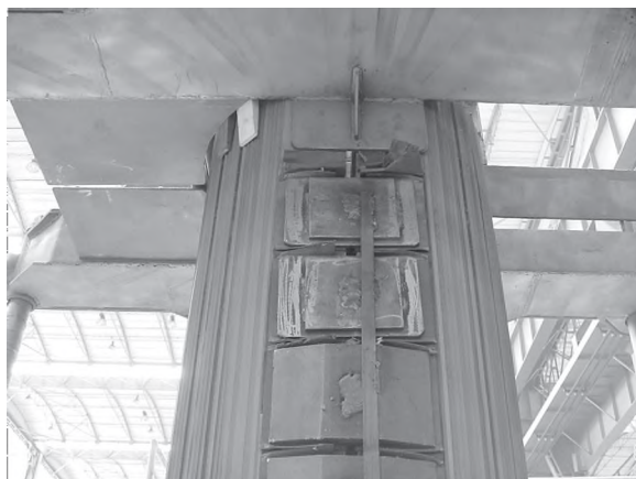
Rys. 3.3. Sworznie i nakładki prasujące rdzenia dwuramowego autotransformatora RTdxP125000/200
