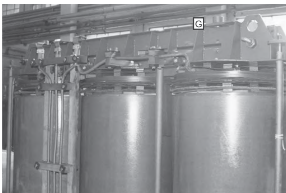
Rys. 3.10. Część wymiawalna transformatora 10MVA/110kV. Rdzeń dwuramowy wzorowany na licencji ELIN-UNION, centrowanie rdzenia w kadzi według „starego” rozwiązania.
