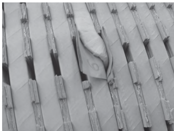
Rys. 3.17. Śrubowe uzwojenie DN autotransformatora RTdxP125000/200 z rozproszonym przeplecieniem wykonywanym przewodem na „plask”.
