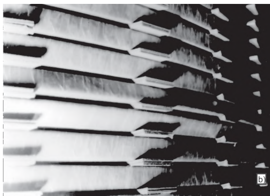
Rys. 3.14. Uszkodzenia transformatora TW240000/220 powstałe po niesynchronicznym załączeniu na sieć, a) wyboczone prawie na całej wysokości uzwojenie DN, b) pochylone przewody uzwojenia GN jako efekt zbyt dużych nacisków osiowych.
