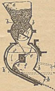
sind an ihren äußeren Kanten mit Leisten zum leichteren Durchstoßen der Kohlenschicht versehen. Bei der Umdrehung gelangt nun die Kohle in ein darunter befindliches, um Welle f pendelndes Gehäuse k mit tangential gerichteten Auswurfsstutzen. Die sich ebenfalls um Welle f drehenden Wurf-schaukeln e schleudern die Kohle auf den Rost.
