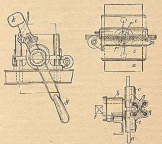
drehbar befestigt und können durch eine mit Excenter oder Doppelkurbel f<sup>t</sup> versehene Welle f, die einen Doppelhebel k g mit einem bekannten Sperrwerk zum Schließen und Oeffnen der Klemmbacken e trägt, eingestellt werden.
