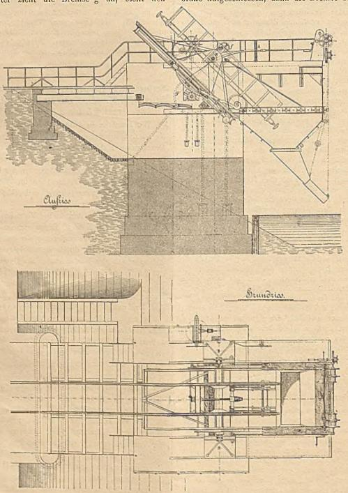
bis der Wagen ganz gekippt ist, und hierauf wieder so lange angezogen, bis sich der Inhalt in den Trichter entleert hat, worauf wieder ein Lösen der Bremse erfolgt und die Bühne in ihre ursprungliche Position
