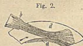
Der Strahl tritt aus einer Düse b in die nach innen sich verjüngende Umfangsrille cd einer leicht drehbaren Räderschleife a,
