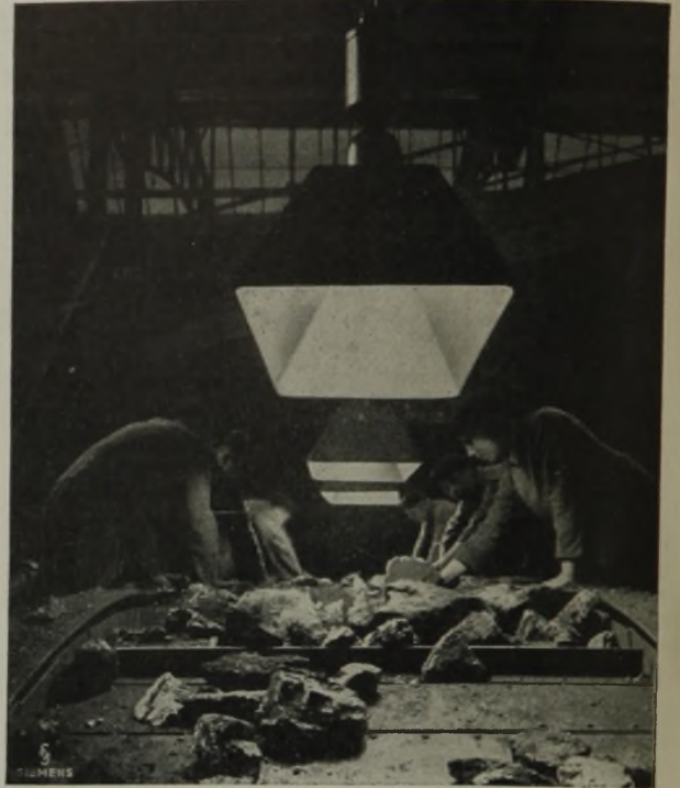
Abb. 4. Lesebandbeleuchtung mit Quecksilberdampflampen.
