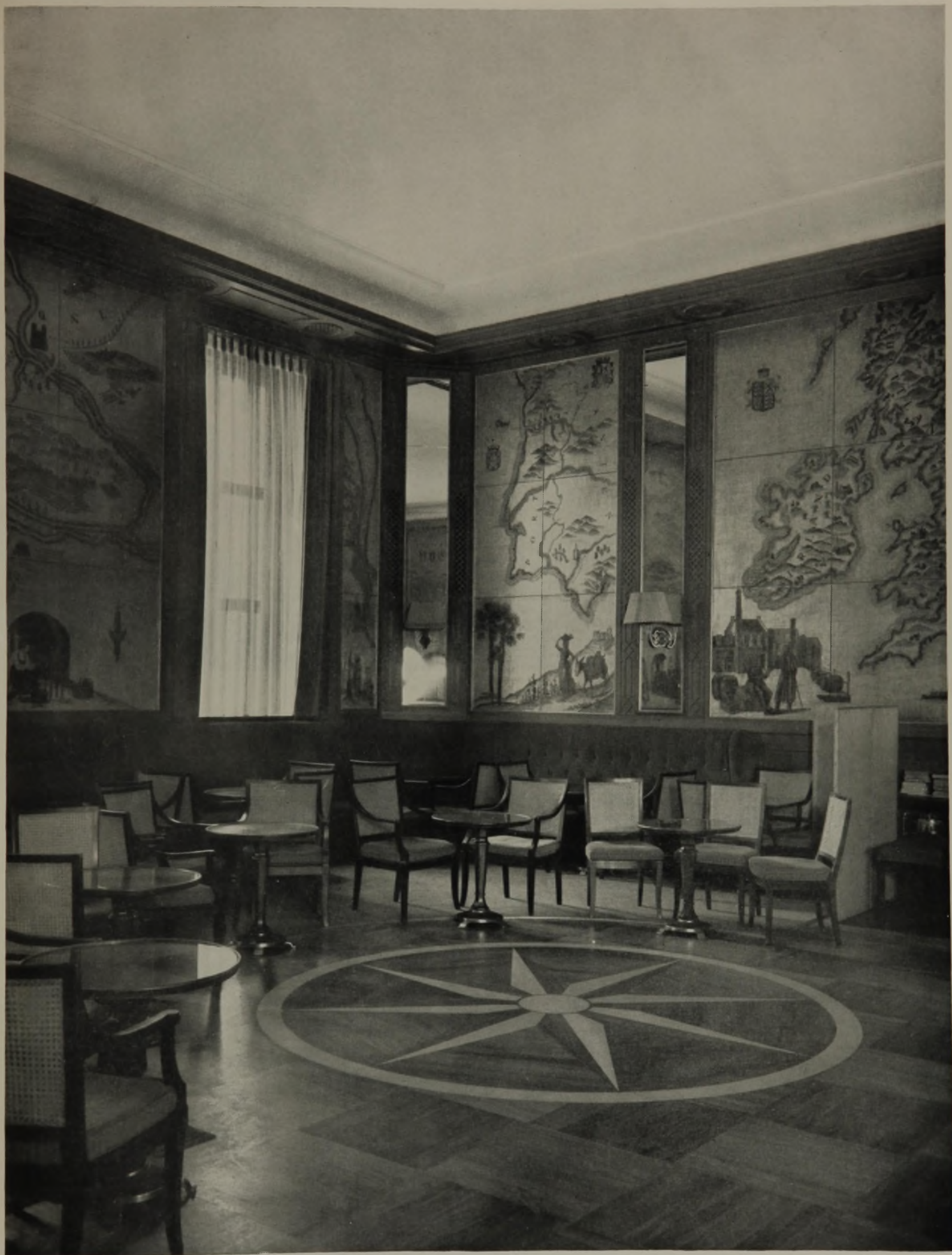
7 Blick in die Fensterecke der Bar. Die Decke wird indirekt beleuchtet. Die Beleuchtung ist auf verschiedene Lichtstimmungen eingerichtet. Malereien auf Goldgrund (Sperrholzplatten) von Karl Heinz Dallinger. Tanzparkett. Bezüge und Teppich in Rot
