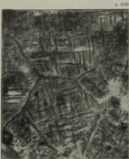
Abbildung 7. Magnesitstein E. Jedes Korn aufgeteilt in zahllose Spaltebenen.
