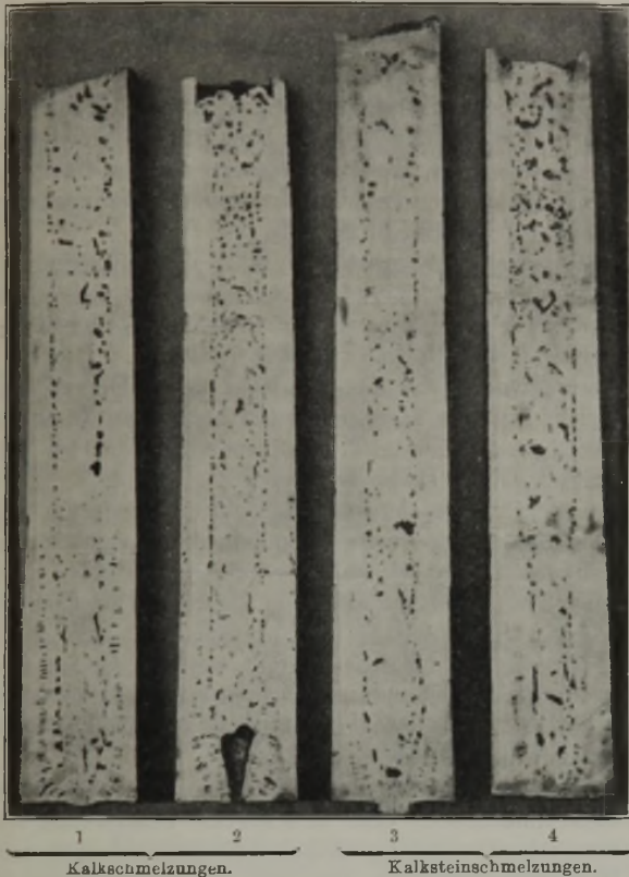
Abbildung 7. Verteilung der Gasblasen in 100-kg-Blöcken (Ferlach).
