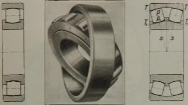
Abbildung 1. Tonnen- und Pendelrollenlager.
