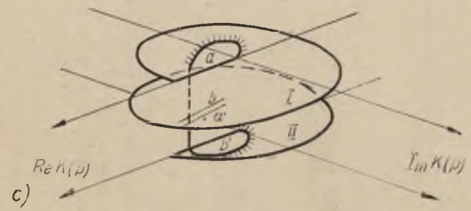
Rys.5. Odwzorowanie konforemne K(p) = \frac{k_0}{ap^2 + bp + 1}
